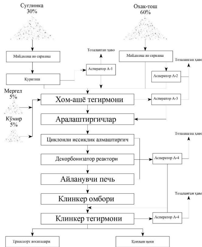
**1-rasm. Quruq usulda sement olish texnologik jarayonida changli gazlarni hosil bo‘lish zonalarining strukturaviy sxemasi**
